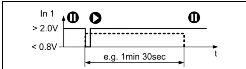
Fig. 66: Arranque ml/min con contador de tiempo de activación por impulso
